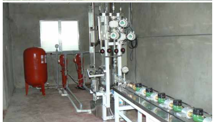
Banco de calibración de medidores por un valor de Lps. 1,850,000.00 (fondos BID)
